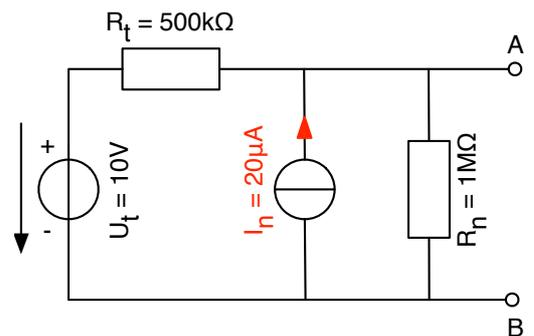
3. Déterminer les schémas équivalents de Thévenin et de Norton, puis calculer en utilisant Thévenin ou Norton la tension  $V_{RL}$ .
